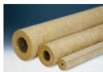
Vinuté izolačné púzdra z minerálnej vlny. Väčšia svojej vysokej objemovej hmotnosti 140kg/m<sup>3</sup> sú určené k tepelnej a zvukovej izolácii rozvodov s teplotou nad 250°C: teplovody, parovody, odvody spalín, vložky komínov a pod.
