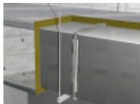
Systém ORSTECH PYRO je univerzálny protipožiarny systém ochrany vzduchotechnického potrubia ur?ený pre použitie na hranaté potrubie s horizontálnou aj vertikálnou orientáciou pri pôsobení požiaru z vonkajšej strany potrubia.
